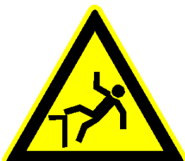
W15 Warnung vor Absturzgefahr
